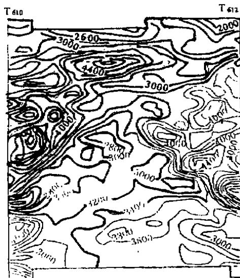
图 2 地震层析成像波速成果
