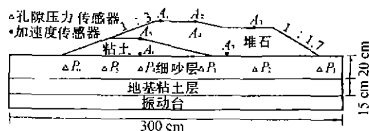
图4 模型断面及测点布置示意图
