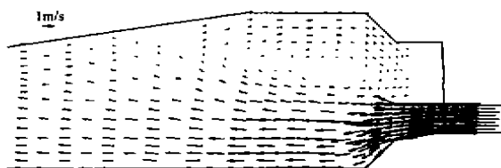
图3 过闸流速最大时的流场
