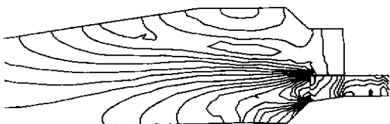
图4 过闸流速最大时的流速等值线
