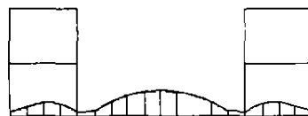
图 2 底板第 200 天时弯矩 (极值: -1645 \text{ kN} \cdot \text{m} )
