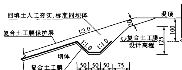
图2 土工膜阻滑槽详图(单位:cm)
