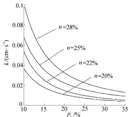
图 4 渗透系数  $k$  与细粒含量  $P_5$  的关系曲线
