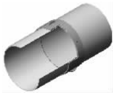
图 1 内衬钢管立体示意图
