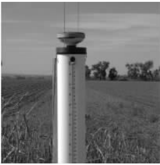
图2 蒸发计的使用 [1]
