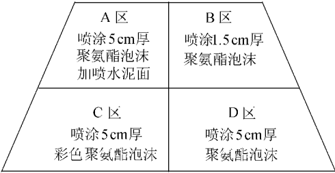
图 1 喷涂聚氨酯泡沫试验分区示意图
