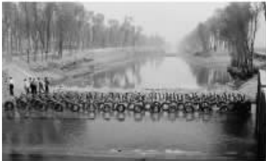
图 1 海漫加糙原型试验现场
