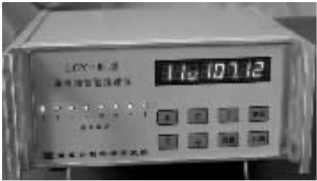
图2 LGY-Ⅲ型多功能智能流速仪
