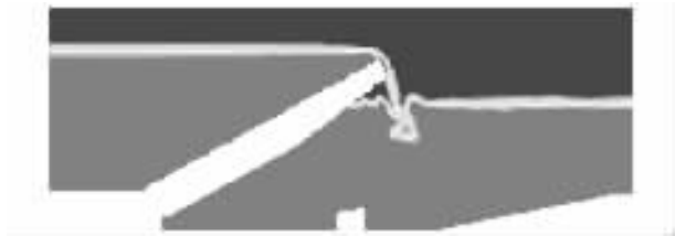
图4 工况 I-1 自由水面形状与掺气现象 ( t = 8.757\text{ s} , VOF 函数空间分布 \alpha_2 )
