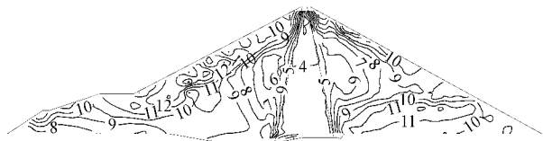
图6 竣工期 E-B 模型弹性模量等值线(单位:MPa)
