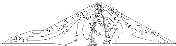
图2 竣工期 E-B 模型应力水平等值线
