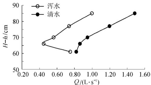
图3 渗渠水深-取水量关系
