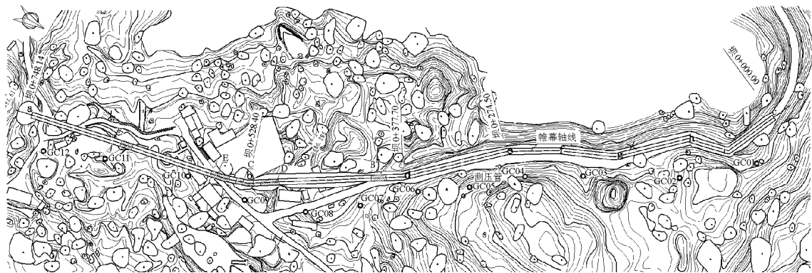
图3 地震堰塞坝体帷幕灌浆布置示意图
