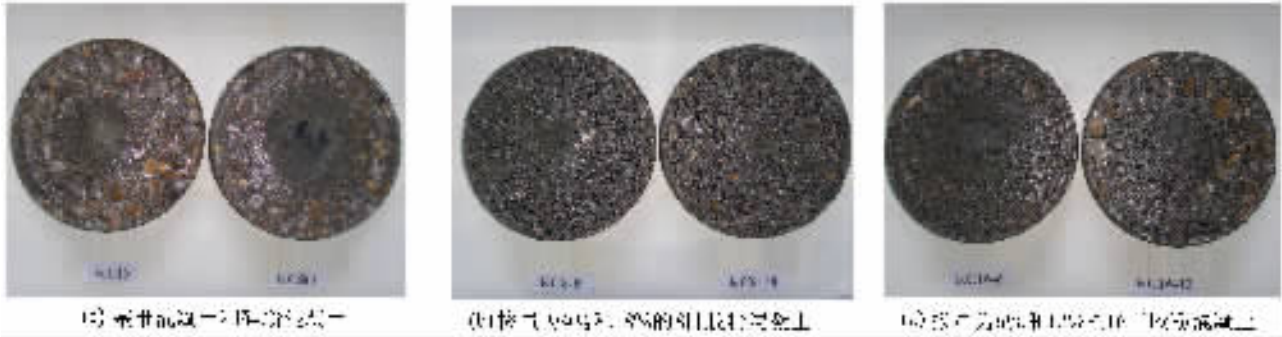
图 1 混凝土试件冲磨后的照片
