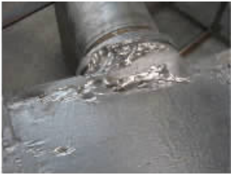
图2 导叶轴径周围的磨蚀情况
