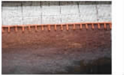
图8 杙槎群梳齿形布置时河岸的冲刷形态
