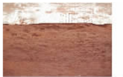
图3 无杙槎群防护时河岸的冲刷形态
