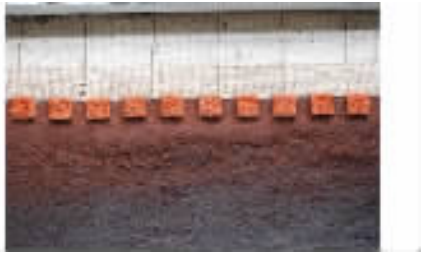
图9 杙槎群间隔布置时河岸的冲刷形态
