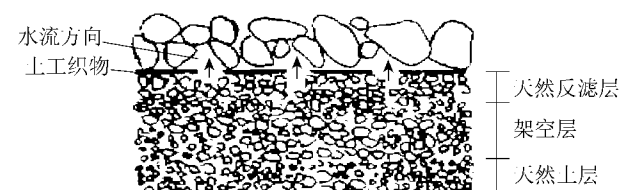
图2 土工合成材料催化土体产生的天然反滤层
