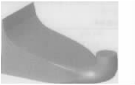
图 2 改造后进水流道透视图
