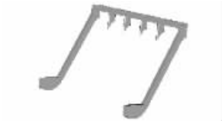
图6 闸墩及导墙模型
