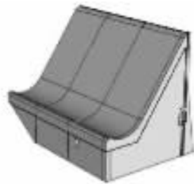
图 3 溢流坝段模型上游侧
