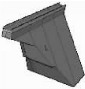
图 1 挡水坝段模型上游侧
