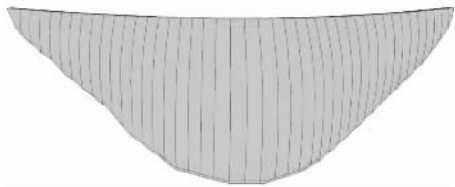
图3 拱坝坝体横缝布置示意图
