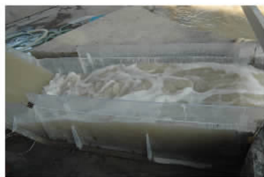
图6 方案6消力池内水流流态
