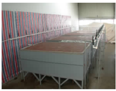
图 1 透水砖地面铺装结构试验装置
