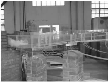
图2 尾坎未上移时设计工况形成的远驱水跃 种解决问题的措施仍以增加工程量为代价。④加高尾坎。这实际上是通过提高第二共轭水深来解决问题,副作用是加剧了消力池的尾水跌落程度,对退水渠流态不利。以上措施皆有不同程度的副作用,有必要寻求新方法。试验表明,通过控制尾坎位置能够消除远驱水跃 [9] ,但这种措施目前研究的较少。为此,本文设计了 1:40 水力学模型试验,提出将尾坎往上游移动 5 m,将尾坎始段位置与渐变段始段错开,旨在避免远驱水跃,解决消力池的消能问题。
