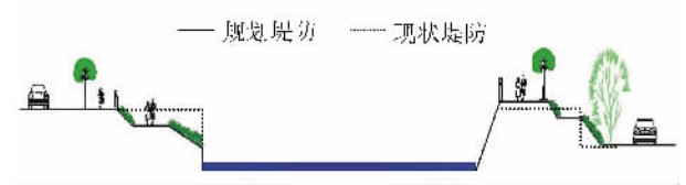
图3 复合扩展式断面示意图
