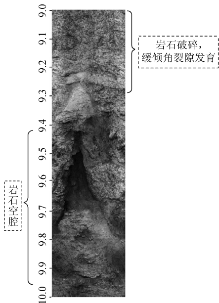
图6 R1004C3钻孔9.0~10.0 m段孔壁岩体状况
