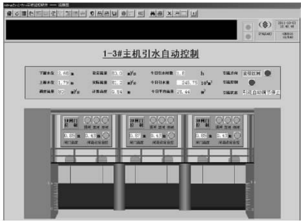
图5 高港泵站1~3号主机自流引江监控界面
