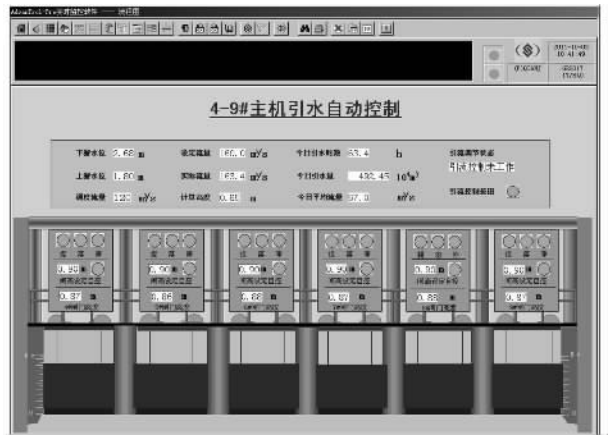
图6 高港泵站4~9号主机自流引江监控界面
