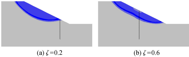
图 7 不同桩位的边坡潜在滑动面
