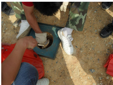
图3 灌砂法压实度检测
