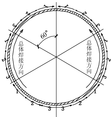
图 2 环缝焊接示意图
