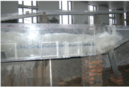
图 4 设计流量时悬栅优化方案 1 池内水流流态
