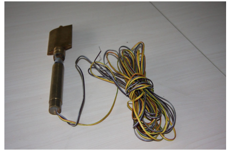
图1 焊接应变片引线的测力活动导叶
