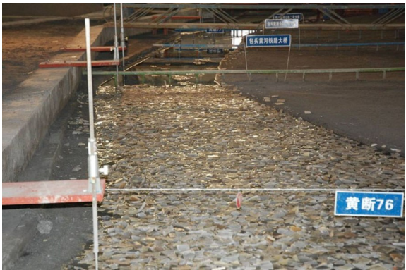
图2 大桥附近的卡冰情况
