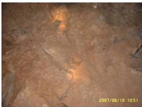
图2 细晶白云岩整体岩溶砂化现象
