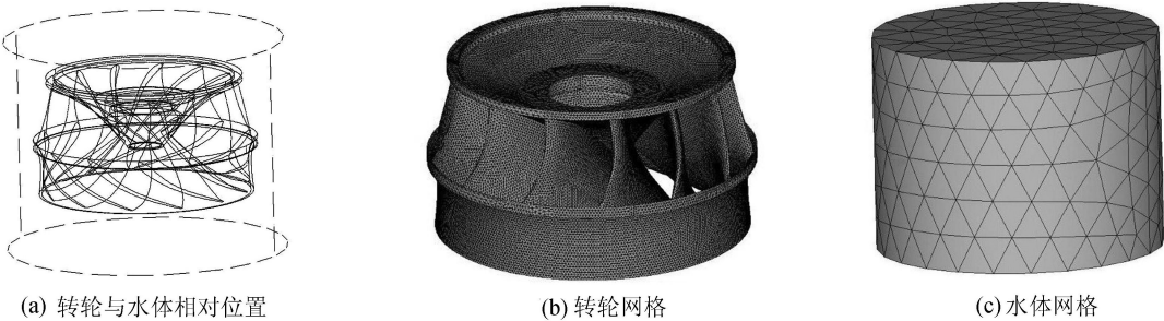
图 1 转轮流-固耦合系统计算模型
