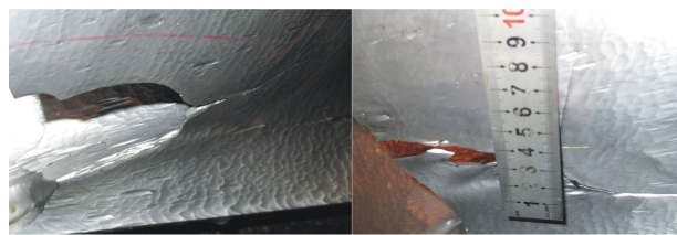
图1 转轮气蚀及裂纹
