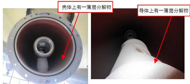
图3 母线上的残留物
