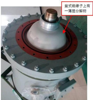
图2 电压互感器上的残留物
