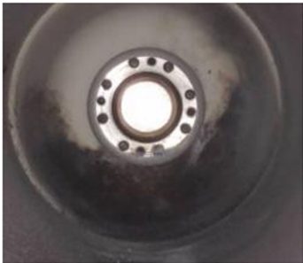
图5 绝缘子放电后情况
