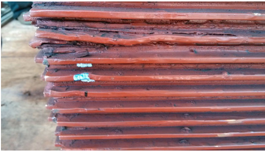
图 2 内部匝间短路点
