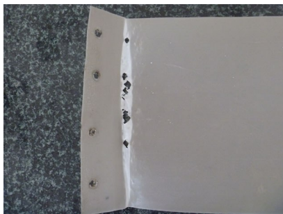
图 6 常规铺设锚固处变形破坏状态
