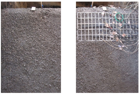
(a) 未加筋模型坝 (b) 复合加筋模型坝
