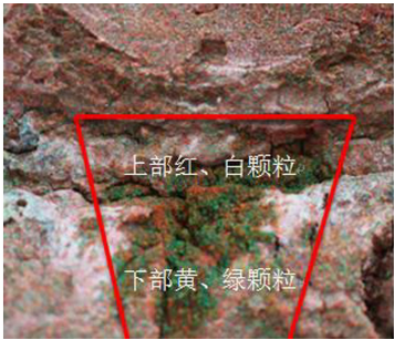
图 14 拱结构部位纵剖面
