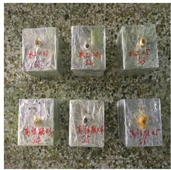
图 3 采用锡箔纸包裹的混凝土试件
