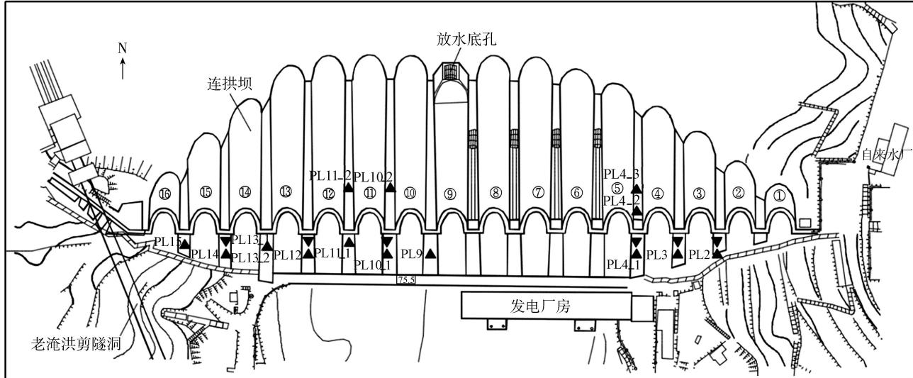
图2 梅山水库水平位移正倒垂线(自动化和人工)测点布置
