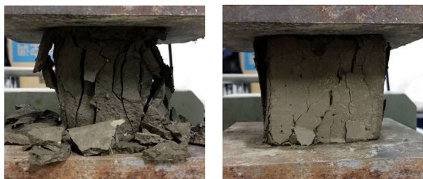
图3 无侧限抗压强度试验破坏形态
