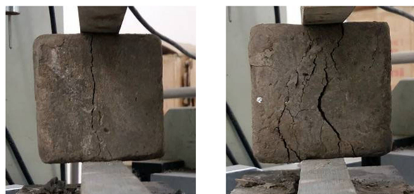
图5 劈裂抗拉试验破坏形态
