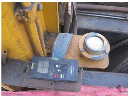
图 3 双轴测柱式电子水平仪
