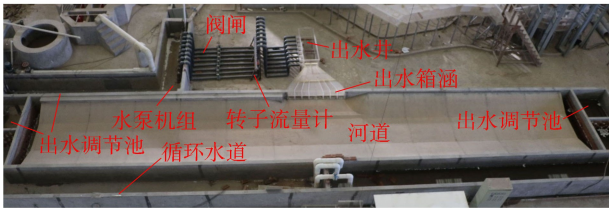
图1 泵站出水系统主体部分水力模型
