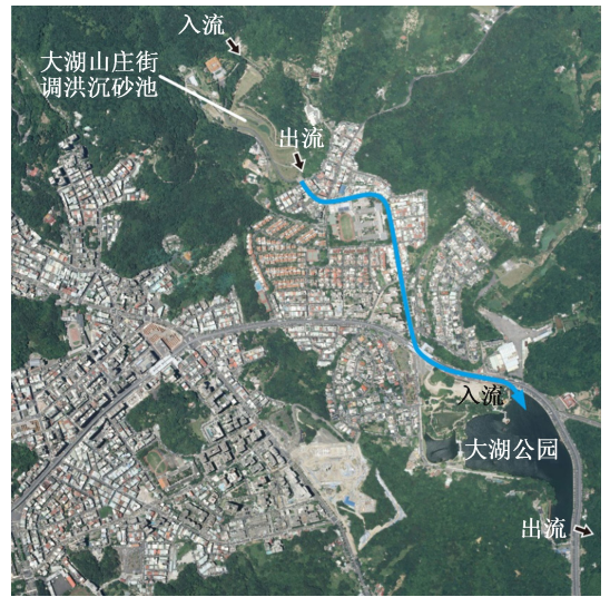
图2 大沟溪生态滞洪池与大湖公园滞洪池水道连通情形 [2]
