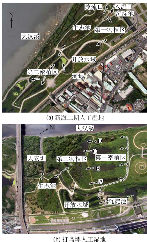
图11 大汉溪河岸人工湿地净水单元配置情形 [6]
