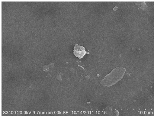
图6 PVC膜装置使用后膜SEM照片
